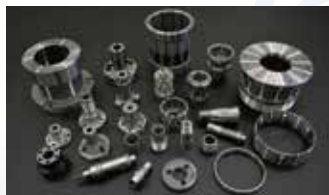
工作機械部品・加工用具・コレット等を 研磨仕上げで製作
