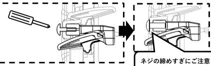
ネジの締めすぎにご注意ください 締めすぎると破損する可能性があります
