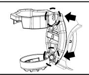
上下左右の合計4か所にネジがあります。 左右どちらかのネジを締めて開閉力の調整をしてください。
